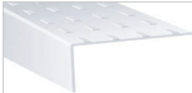
Sonderprofil aus V2 A Edelstahl, 1.4301 mit 4 Reihen Trittschutznocken Stärke 1,5 mm, Auflage 100 mm, Höhe 45 mm
