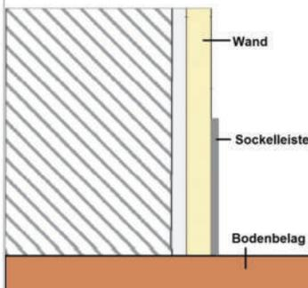
Abkant-Sockelleiste aus Edelstahl zur Wandverkleidung. Mit 10 mm breiter, 94° Ankantung als Überdeckung zum Bodenbelag.
