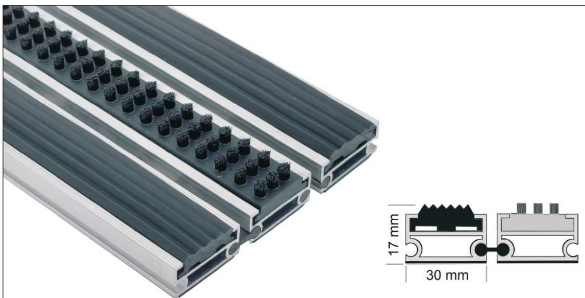
Eingelassene widerstandsfähige, witterungsbeständige und gerillte Kunststoffeinlage im Wechsel mit dreireihiger Polyamidbürstenleiste. Durchmesser der Bürstenbündel 4 mm. Brandklasse B2 nach DIN 4102. **(Kunststoffeinlage Brandklasse B1 möglich)**
