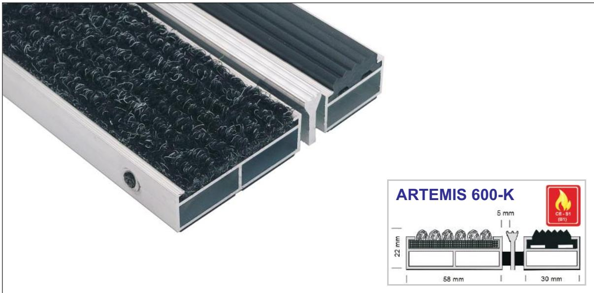
Eingelassene, widerstandsfähige, witterungsbeständige und gerillte Rauhhaarrips-Einlage im Wechsel mit gerillter Kunststoff-Einlage. Zusätzlich mit Alu-Kratzkante zur Erhöhung des Schmutzabriebs.
